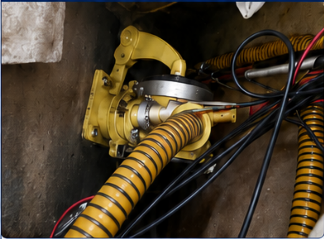
Bomba Bosworth Guzzler® 500 instalada bajo la bañera. Accionamiento desde la bañera (cockpit).
